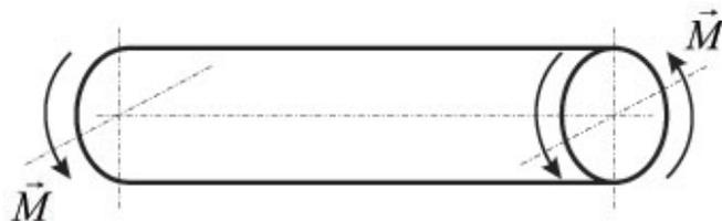
Рис. 3. Схема эксперимента по кручению цилиндра
