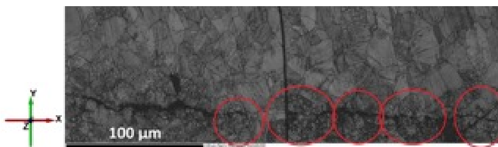
Рис. 4. Микроструктура на полированной поверхности пластины в области залеченной трещины после электроимпульсной обработки (контраст изображения иллюстрирует качество картин Кикучи в EBSD анализе: в более темных областях информации для определения разориентировок кристаллов недостаточно). Кружками обведены области с мелким зерном, в которых берега трещины оказались залечены закристаллизованным расплавом - образовались перемычки
