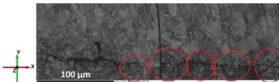
Рис. 4. Микроструктура на полированной поверхности пластины в области залеченной трещины после электроимпульсной обработки (контраст изображения иллюстрирует качество картин Кикучи в EBSD анализе: в более темных областях информации для определения разориентировок кристаллов недостаточно). Кружками обведены области с мелким зерном, в которых берега трещины оказались залечены закристаллизованным расплавом - образовались перемычки
