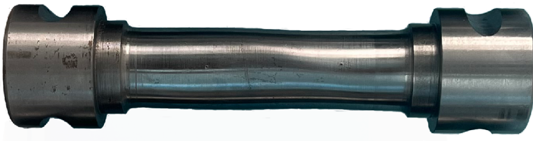
Рис. 1. Оболочка после испытаний
