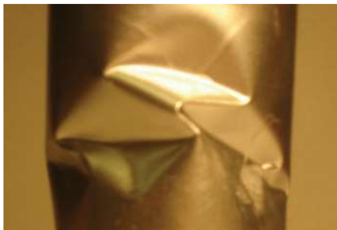
Рис. 2. Вид образца в зоне потери устойчивости
