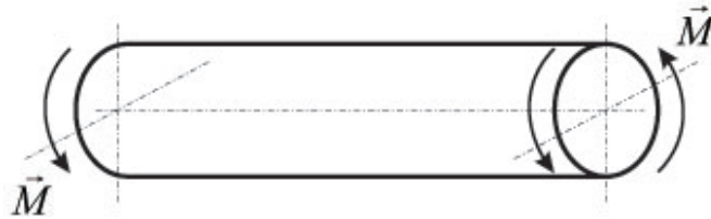
Рис. 3. Схема эксперимента по кручению цилиндра
