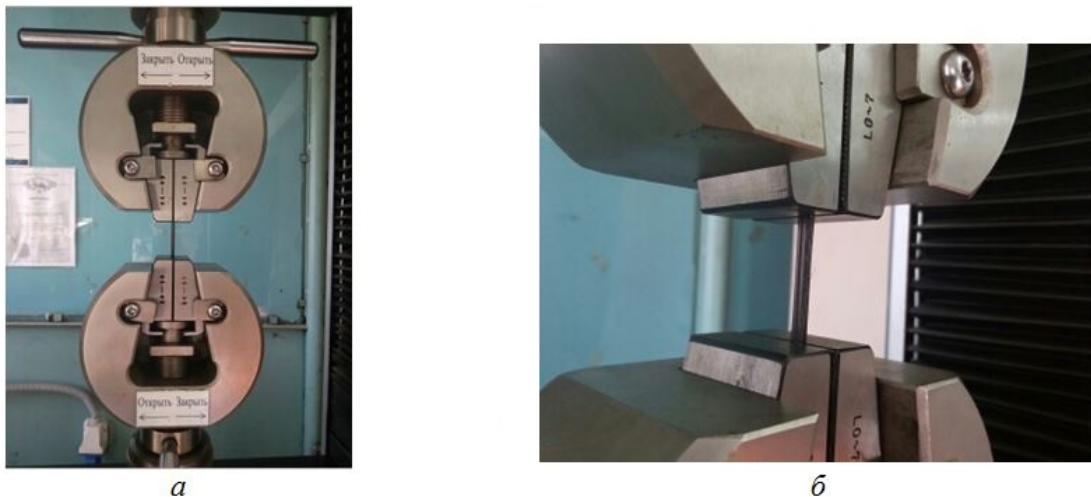
Рис. 2. Рабочая зона установки ИР 5082-100 (а) и испытываемый образец в захватах (б)
