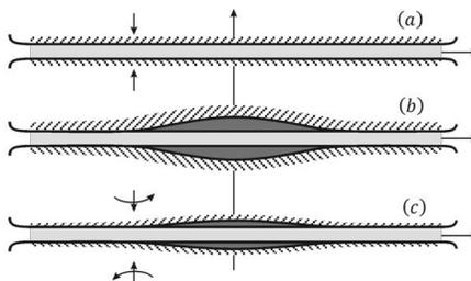
Рис. 3. Осесимметричная пластическая осадка тонкого слоя вращающимися телами с удержанием промежуточного объема смазки
