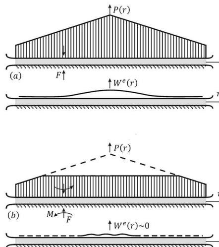
Рис. 2. Эпюры распределения контактного давления и нормальных упругих перемещений контактных поверхностей тел инструмента в случае:
