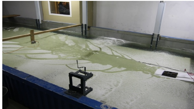
Рис. 3. Характер разрушения модельного льда.
