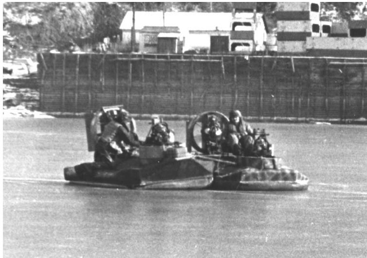
Рис. 1. Спаренная работа СВП "КнАПИ-1" и "КнАПИ-2" при выходе на берег
