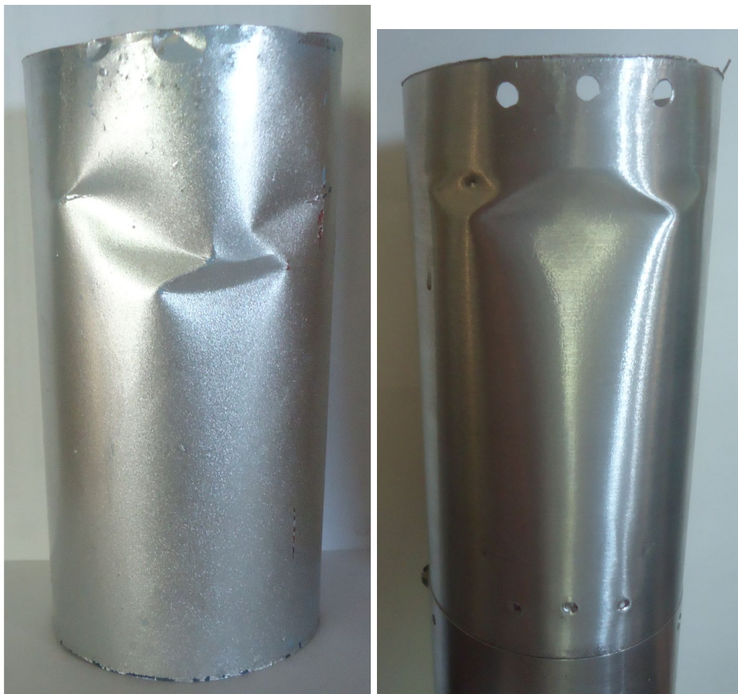
Рис. 2. Форма оболочки после снятия нагрузки: а) образец серии 1 ( h/R=0,003 , L/R=4,12 ), б) образец серии 5 ( h/R=0,01 , L/R=8,3 )
