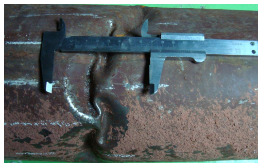
Рис. 2. Образец без подкрепления (фрагмент центральной части оболочки после потери устойчивости)
