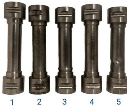
Рис. 6. Образцы после испытаний (1 – растяжение, 2 – кручение, 3 – сжатие, 4 – пропорциональное растяжение с кручением, образец 5 – пропорциональному сжатию с кручением).
