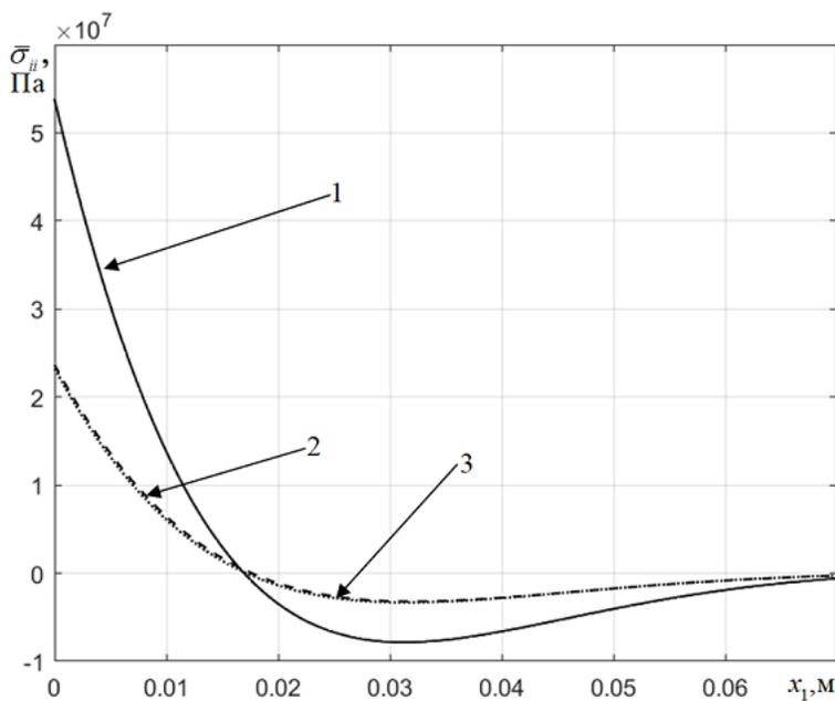
Рис. 4. Напряжения в адгезионном слое Sikaforce 7752
