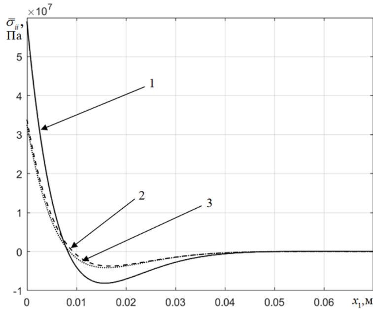
Рис. 2. Напряжения в адгезионном слое Araldite AV138
