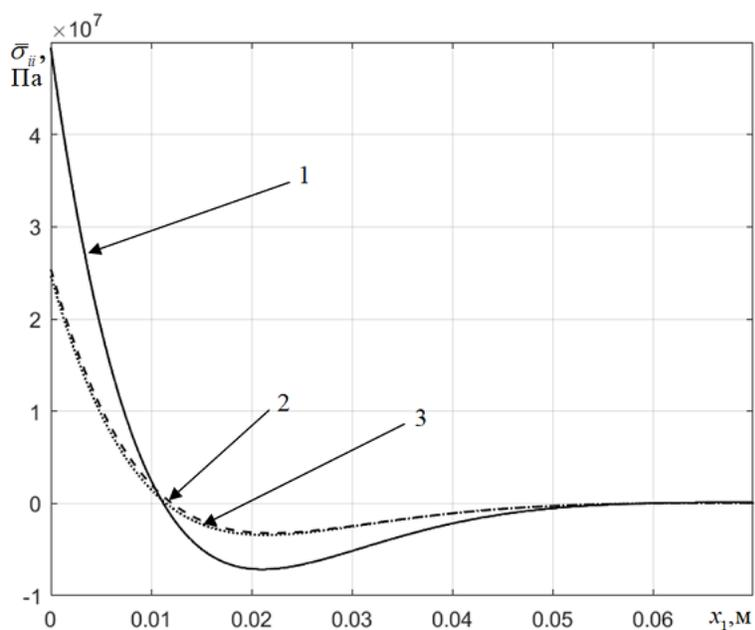
Рис. 3. Напряжения в адгезионном слое Araldite 2015
