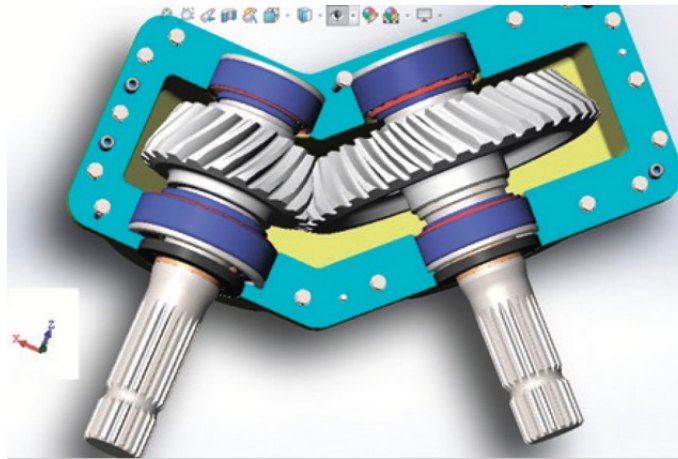
Рис. 2. Твердотельные модели конического редуктора
