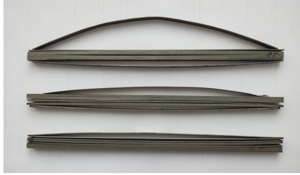
Рис. 6. Изгибы полос, нарезанных из образцов проката после градиентной термомеханической обработки (сверху вниз: С, В, А, сторона закалки сверху).
