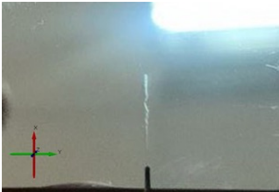
Рис. 1. Вид образца в области пророщенной длинной усталостной трещины. Система координат, XY – в плоскости пластины
