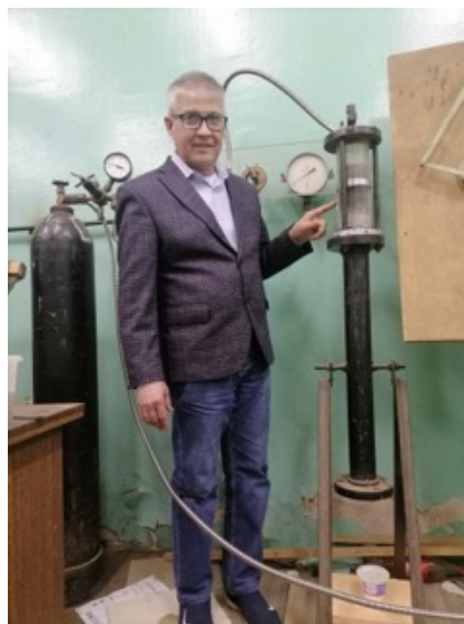
Рис. 1. Лабораторная установка для определения параметров водоизолирующего слоя
