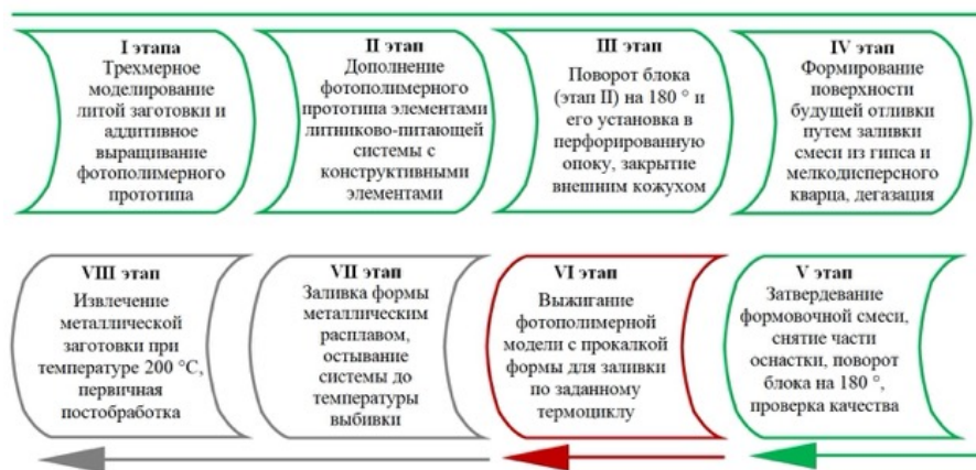
Рис. 1. Схема технологического процесса литья по выжигаемым моделям
