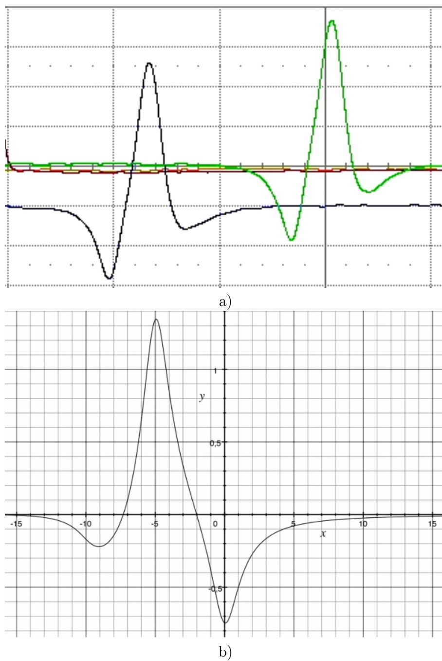
Рис. 5. (а) напряжение на антеннах при пролете цилиндра из оргстекла удлинением 12 со скоростью 229 м/с.; (б) результат расчета.
