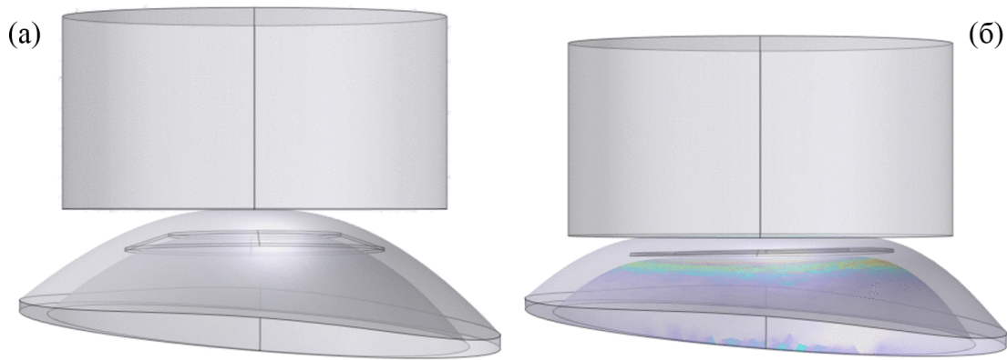
Рис. 4. Модель аппланации роговицы жестким штампом (аппланационной линзой): а — начальное положение; б — конечное положение штампа
