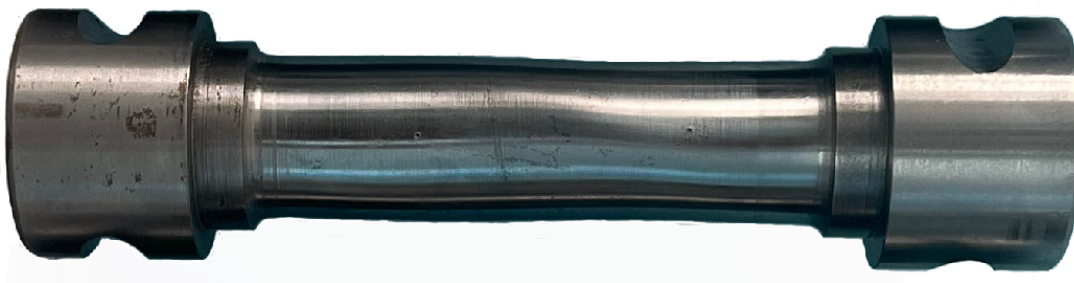
Рис. 1. Оболочка после испытаний
