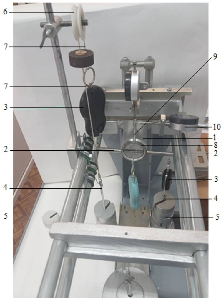
Рис. 2. Специальная экспериментальная установка для испытания на устойчивость при изгибе с кручением.
