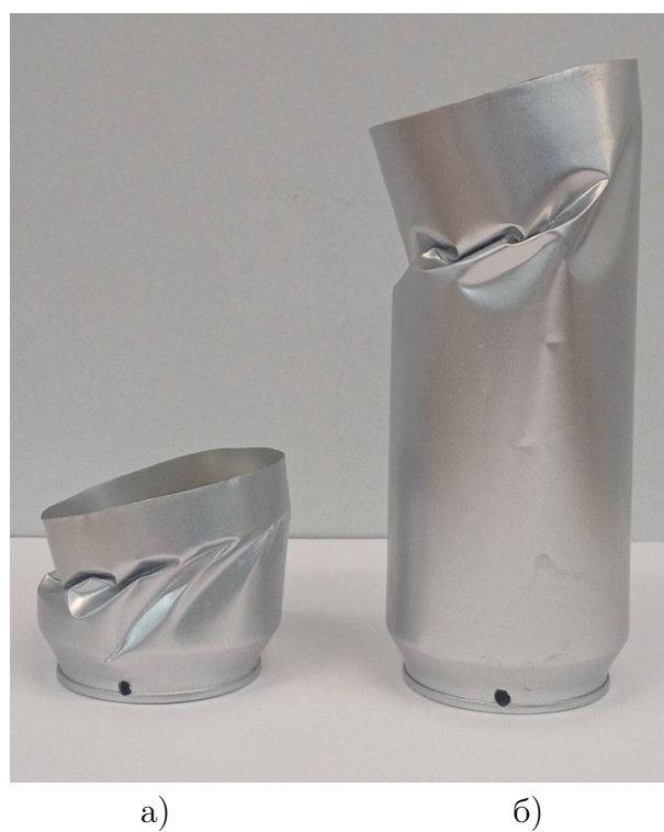
Рис. 5. Образцы первой и второй серий испытаний после полной потери устойчивости
